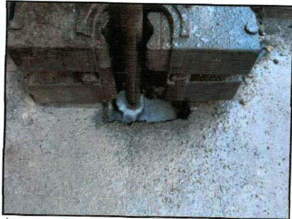
Avanzamento a distruzione di nucleo con circolazione diretta di acqua
