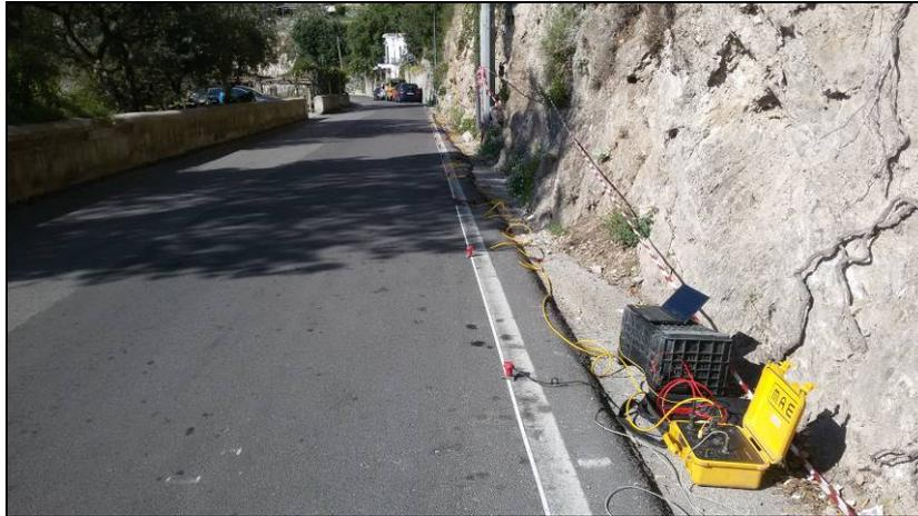
Attrezzatura prova sismica
