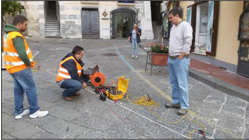
Attrezzatura prova sismica
