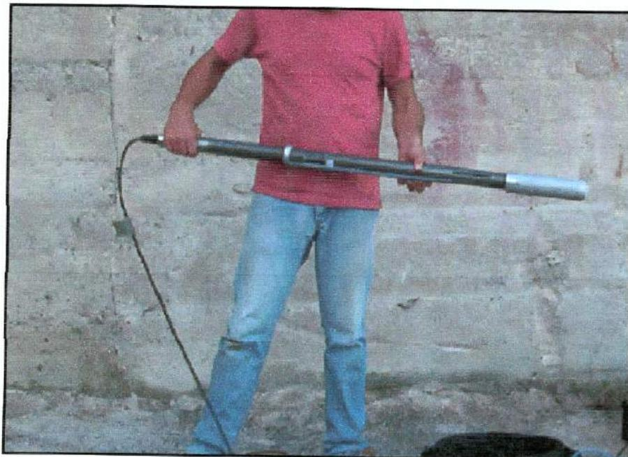
Le registrazioni vengono effettuate disponendo il geofono a profondità variabili all'interno del foro, con distanza fra due misure successive prestabilita (nel nostro caso 2,00 m), utilizzando un apparato di registrazione costituito da un sismografo a più canali.
