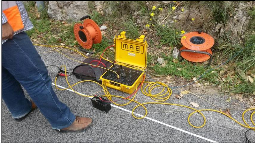
Attrezzatura prova sismica
