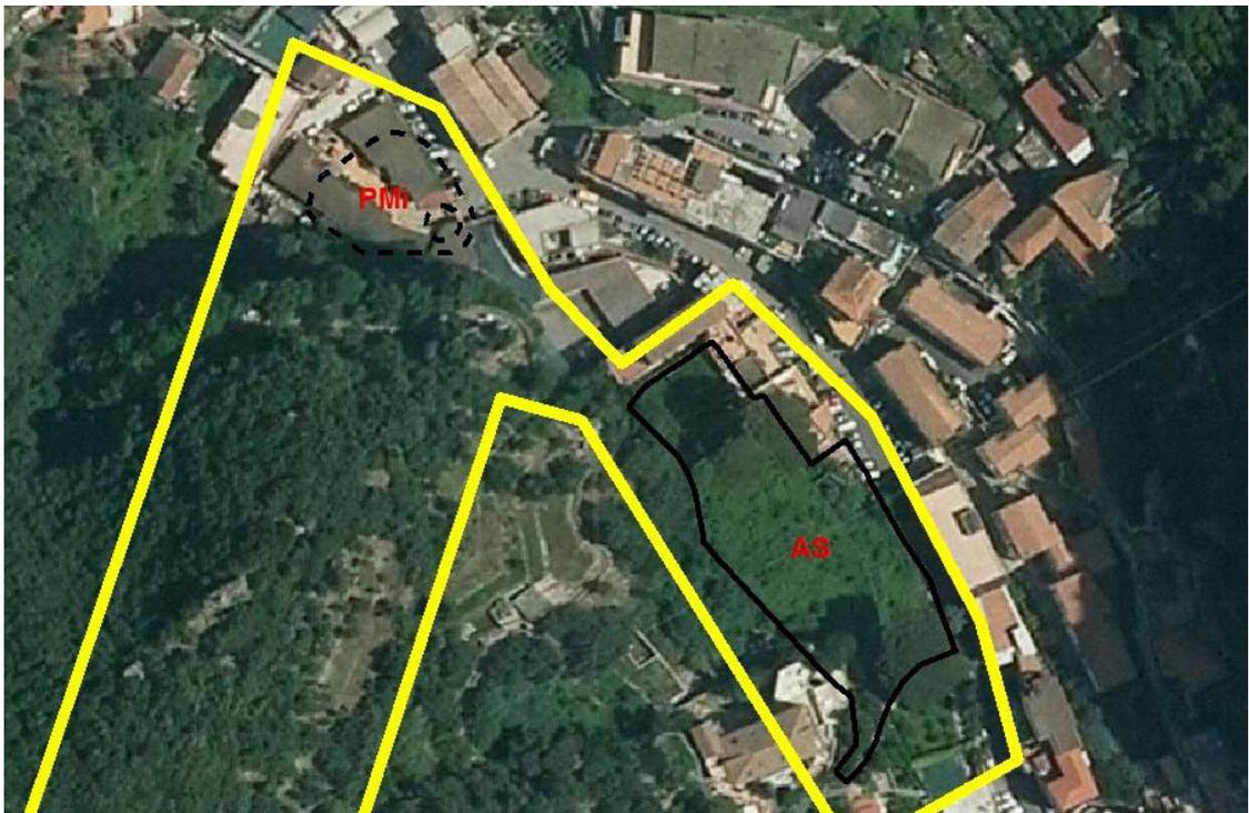
Testata Nord: previsione delle aree individuate per realizzazione parcheggio multipiano interrato (PMi) e autostazione per bus (AS)
